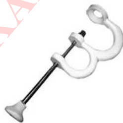
Рис. 28. Приспособление для выдавливания косточки из вишни
